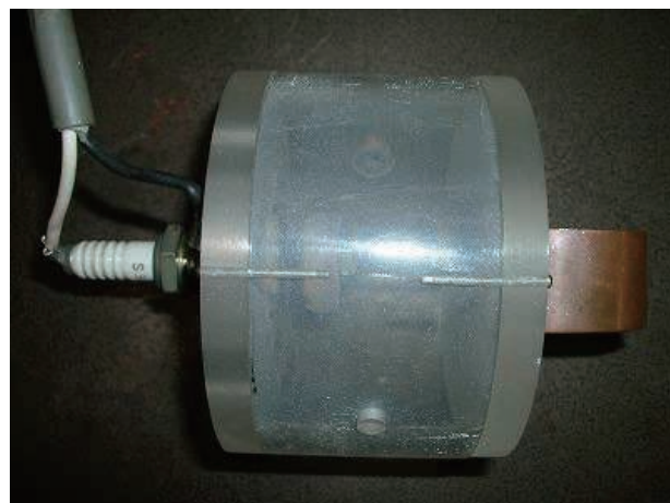
写真4 遠隔操作放電スイッチ
