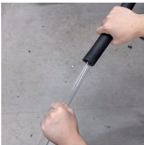
石英管をホースに接続する作業
