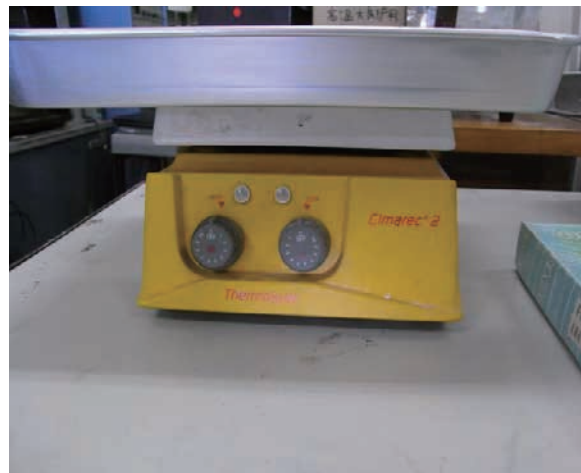
ホットプレートの制御装置。 タイマーと強度のみが制御できる。
