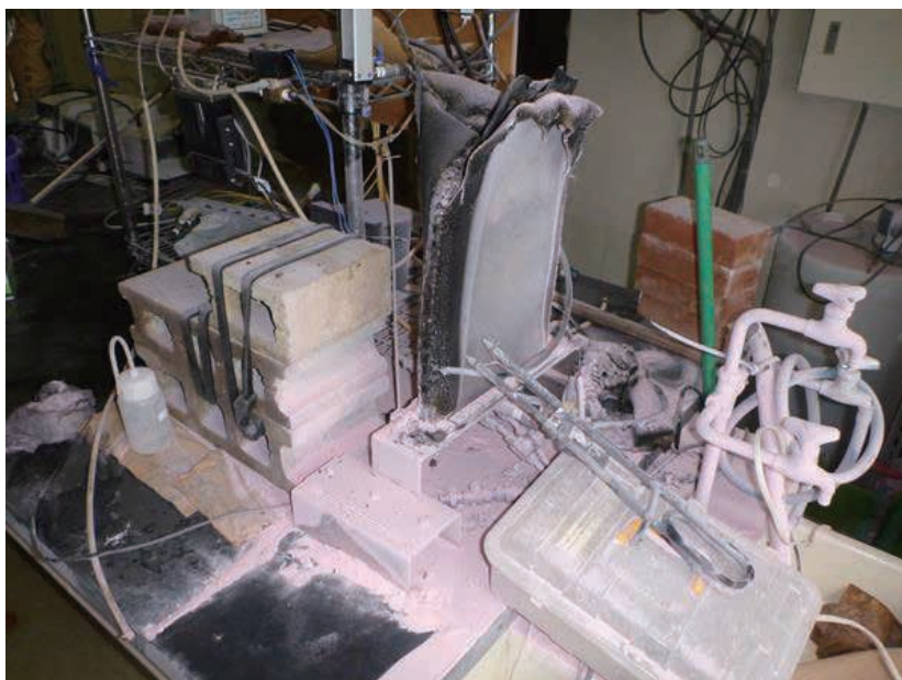
【焼失した試験装置：中央の黒い容器がプラスチック製水桶】
