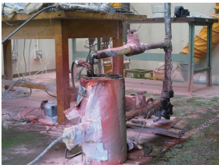
電気ヒーターで油を加熱していた容器（消化活動後）
