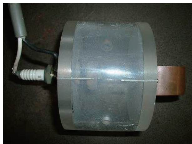
写真4 遠隔操作放電スイッチ
