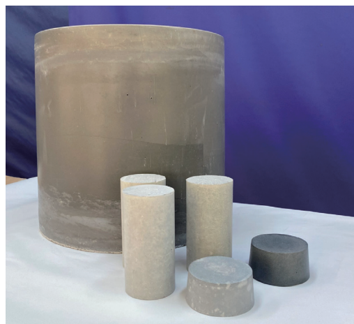
③ 試作したジオポリマー固化体
