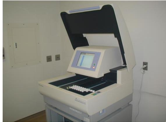
図 8-7 液体シンチレーションカウンタ
