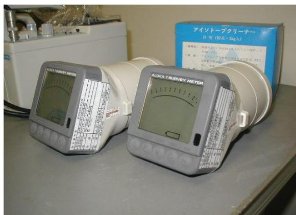
図 8 - 6 電離箱式サーベイメータ
