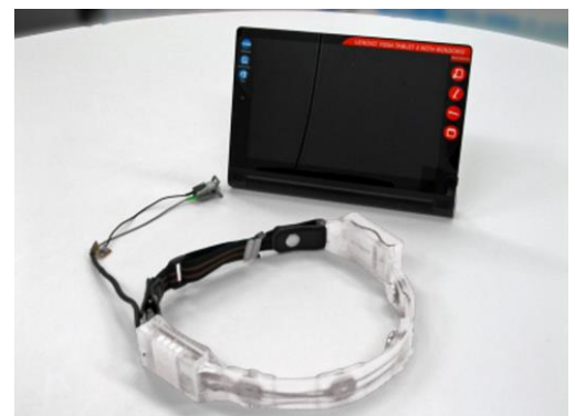
写真 事業展開に向けて開発した感性計測装置
