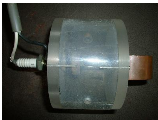
写真4 遠隔操作放電スイッチ
