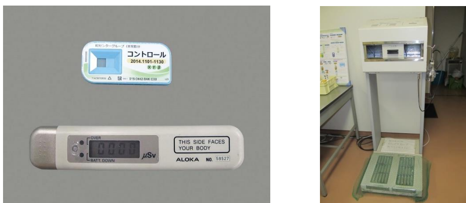
図 8-5 個人線量計と手足衣服の汚染検査装置(ハンドフットクロスモニタ)
