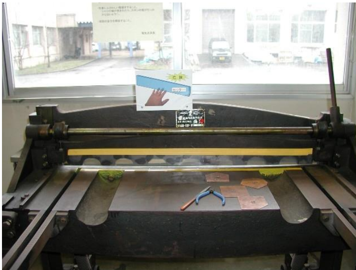
足踏み切断機（改善後）
