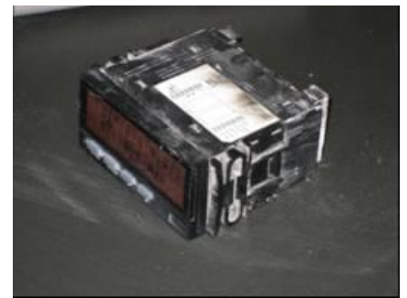
一部が焼けた電圧表示
