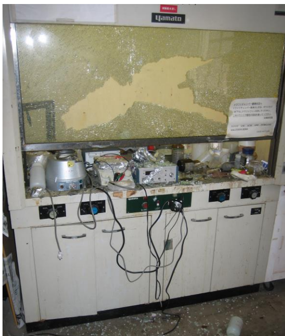
事故後のドラフトチャンバー 内側からガラス瓶が破裂したため、前面ガラスが破損した。
