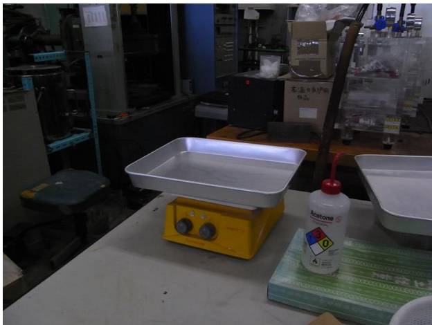
過熱を起こしたホットプレート及び周辺の様子。 発火は図中の金属プレート上である。
