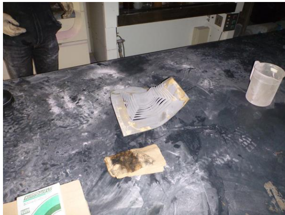
【熱で溶けた天井スピーカーのプラスチックカバー】
