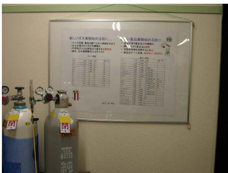
写真2 危険、可燃性がある薬品、ガス及びその組み合わせの掲示
