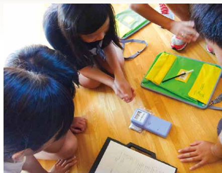
カリ肥料からの \beta 線検知とアルミ板での遮蔽
