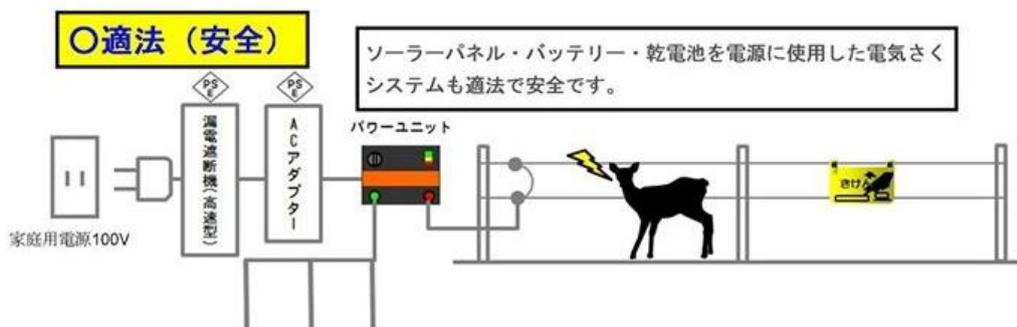
図1 家庭用電源100Vを電源とするパワーユニット(電気さく用電源装置)を使用した電気さく
