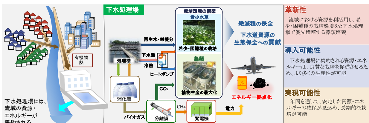
図1 下水処理場での流域内の資源・エネルギー管理と植物生産への活用
