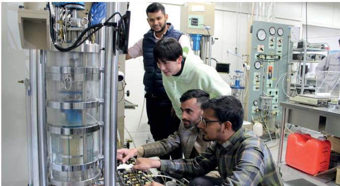
土質試験用三軸実験装置
