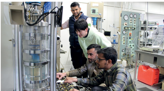
Хөрсний туршилт хийх гурван тэнхлэгт аппаратыг бэлтгэсэн
