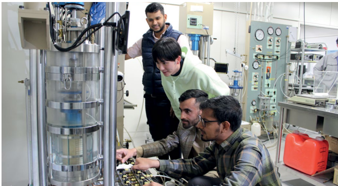
Thiết bị ba trục được chuẩn bị để thử nghiệm đất
