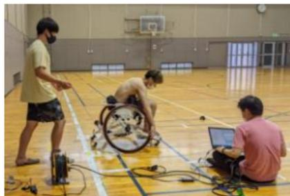
バドミントン競技用車いす開発のための片手チェアワークによる駆動特性評価
