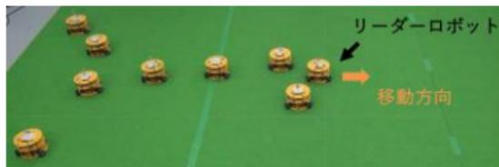
図. 移動ロボットから成るロボット群の誘導制御の様子。群れ形状を保ったままでの移動が必須。
