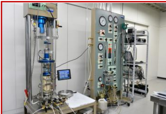
土の要素試験 (微小ひずみ測定三軸試験) : 繊細な作業です
