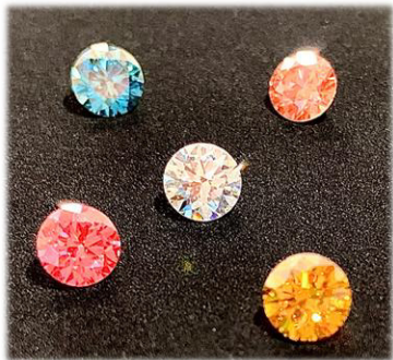
ブリリアントカットした0.5カラット人工合成ダイヤモンド
