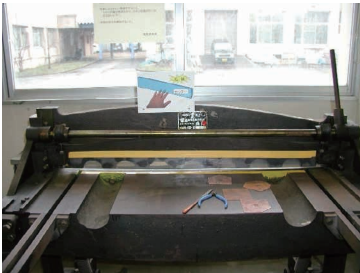
足踏み切断機（改善後）
