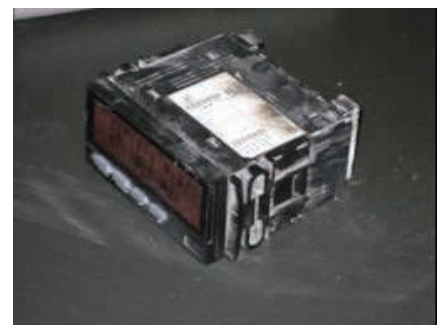
一部が焼けた電圧表示
