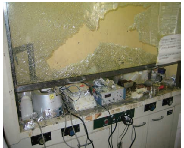
事故後のドラフトチャンバー 内側からガラス瓶が破裂したため、前面ガラスが破損した。
