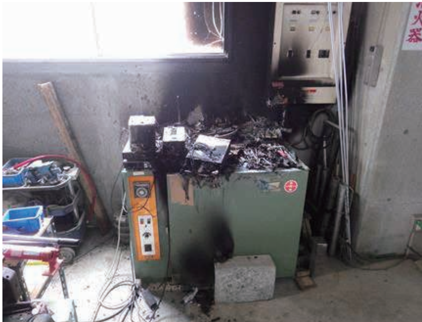
焼け焦げた乾燥炉
