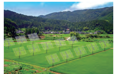
図1 高透過性太陽電池の設置イメージ
