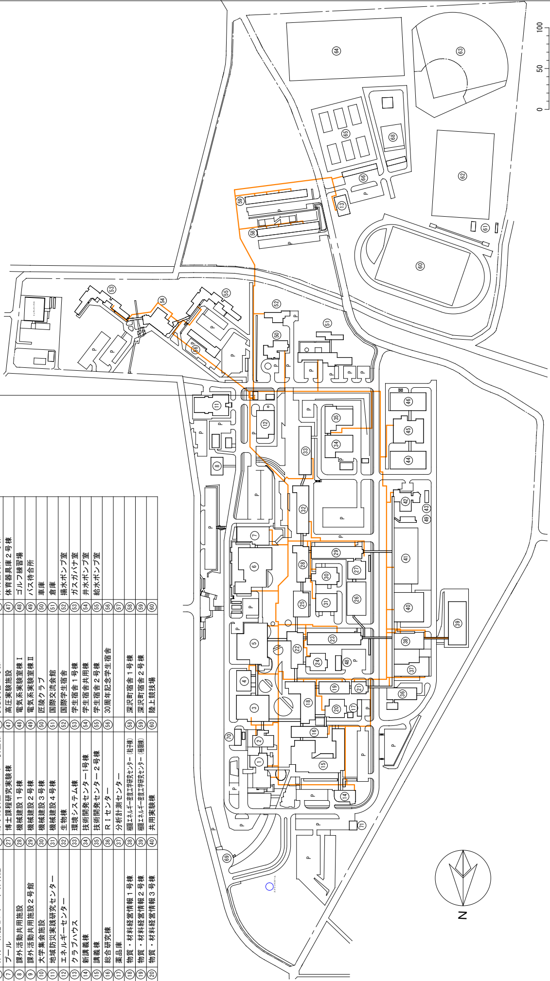
ガス配管系統図 S=1/4, 500
