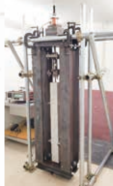
実験の様子（鉄筋コンクリート試験体に一軸引張力を加える実験）
