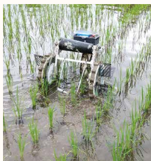
▲ 小型車輪走行除草ロボットの实証
