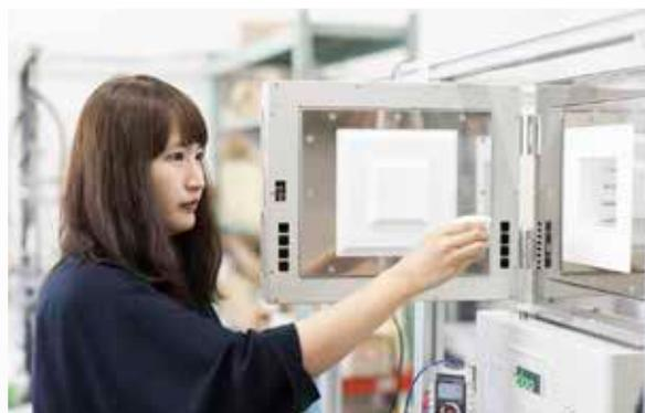
材料の焼結を行うため、電気炉に試料をセットしている様子
