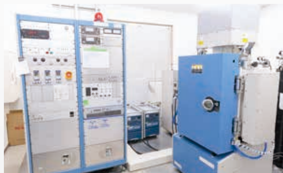
ステンレス鋼に表面処理を施すイオンブレイティング装置
