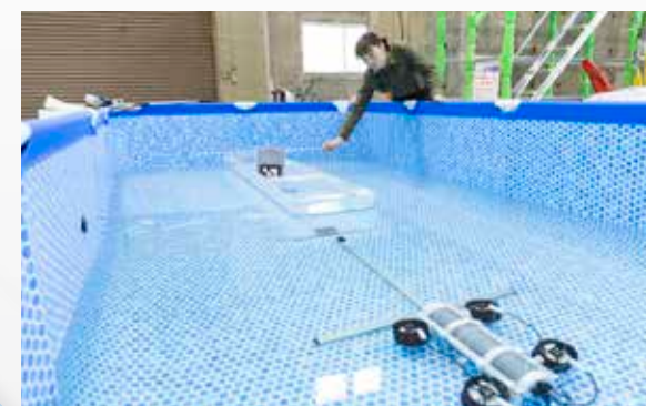
現在開発中の「濁水中での水中ロボットのカメラ性能の評価試験法」について検討している様子
