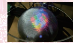
球の中に3D映像が見えるライトフィールド3Dディスプレイ。球形のため周囲の広い範囲から多数で同時に見ることができる。
