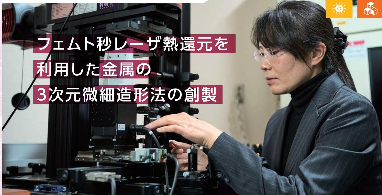
フェムト秒レーザを用いた3次元微細造形は、原料内部に集光したレーザパルスの焦点近傍のみで生じる多光子励起光還元析出を利用して金や銀において実現されています。しかしながら、銅(Cu)やニッケル(Ni)などの光還元析出の困難な金属や合金の造形には応用できません。そこで、フェムト秒レーザ照射時に発生する熱エネルギーを熱還元に利用した3次元微細造形を取り組んでいます。これまでにCuやNiの酸化物ナノ粒子を還元剤と混合したインクを調製し、熱還元焼結により金属の2次元・3次元微細造形を行ってきました。特に、レーザ照射速度やパルスエネルギーを変えることで、描画パターンの還元度を制御することができるため、例えば抵抗温度依存性の小さな金属的なCu-richパターンと、逆に温度上昇に伴い抵抗が大きく減少する半導体的なCu<sub>2</sub>O-richパターンを選択的に描画形成し、測温部をCu<sub>2</sub>O-rich、配線分をCu-richとする、高感度な温度センサの試作へ応用しました。その
