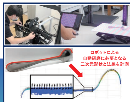
図1.提案技術によるカトラリーの三次元形状計測(上)実験風景(下)実験結果
