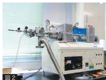
図2 窒素熱処理を行う赤外線加熱炉
