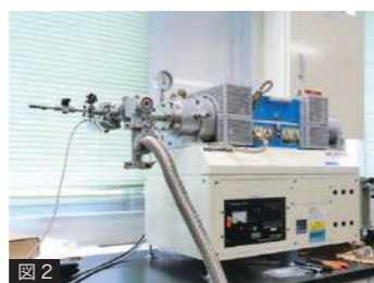
図2 窒素熱処理を行う赤外線加熱炉
