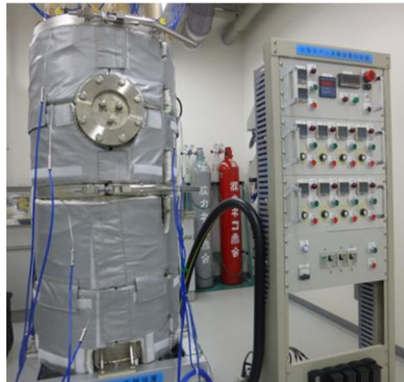
図1 模擬容器と制御盤
