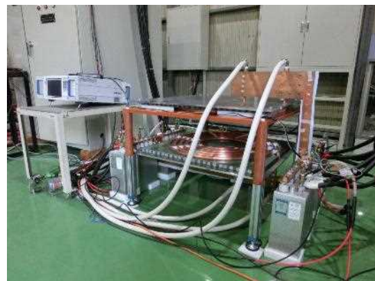
(a) システム全体像 (b) 水冷構造を採用した伝送コイル
