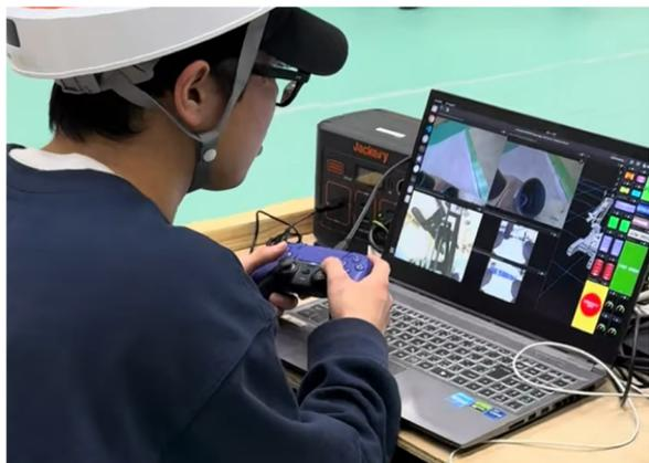
【図2】オペレータによる遠隔操縦の様子
