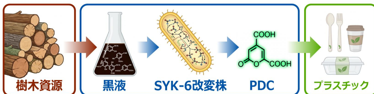
研究概要図：製紙廃液（黒液）から SYK-6 代謝改変株を用いた プラスチック原料・PDC への変換プロセス
