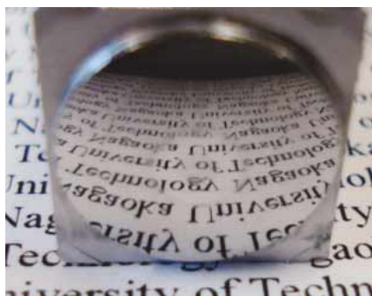
超音波振動援用加工による鏡面仕上げ面
