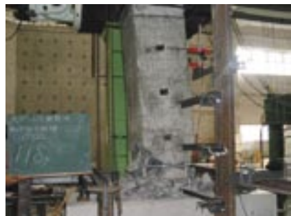
鉄筋コンクリート柱の交番載荷試験
