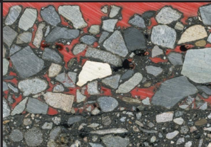
写真-2 ポラス舗装の断面
