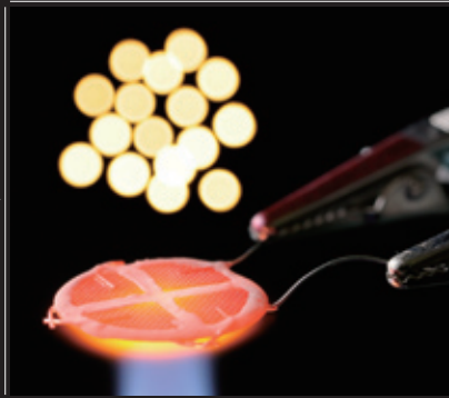
加熱中の直接火炎型燃料電池(右の写真の背景はその電力で発光したライト)
