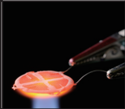
加熱中の直接火炎型燃料電池(右の写真の背景はその電力で発光したライト)
