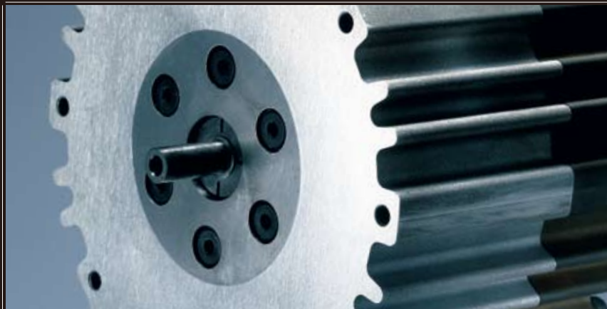
車載スーパーチャージャ用 15,000r/min-1.5kW 超高速モータプロトタイプ
