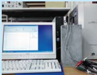
実務訓練において実験で使用している装置と測定データ例。電柱を模した鉄筋入りのコンクリートの中のインピーダンス測定を行い、その結果から環境に配慮した長期間信頼性の電柱の内部構造評価を行います。
