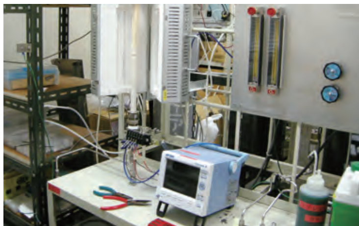
試料(燃料極または空気極)の放電特性評価装置
