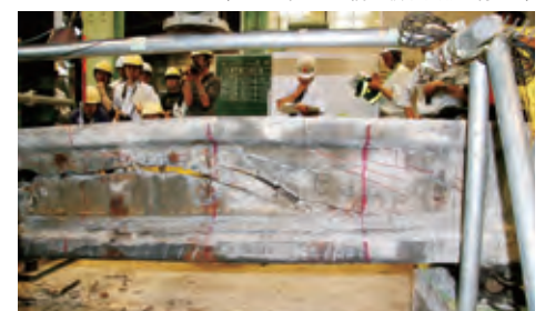
歩道橋の破壊状況
