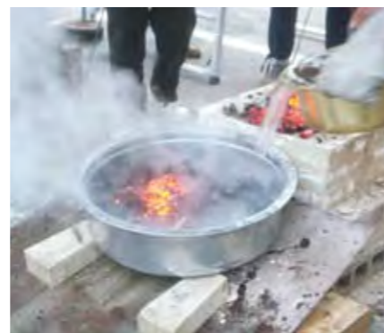
製錬された鋼の冷却
