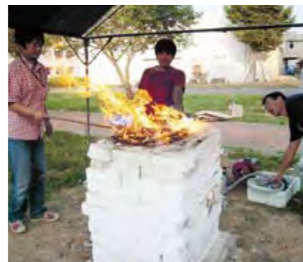
製鉄終盤、煙突を外し炉を解体
