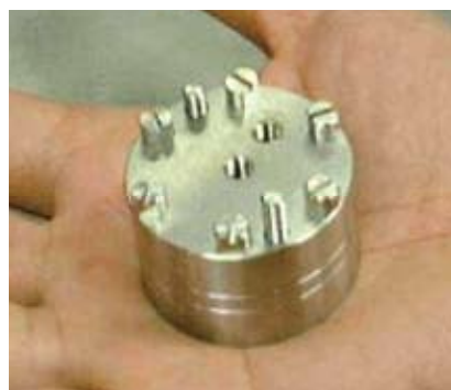
MCP技術で使われるマイクロリアクターの例。将来プラスチックはこのようなものに置き換わるかも。
