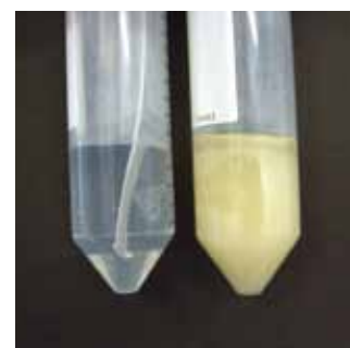
一晩浸けておいたときの濾紙(セルロース)の分解(左:水 右:カビによって分泌されたセルラーゼ)
