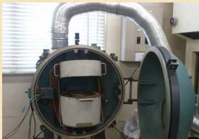
写真1 走査型断熱式熱量計。二次電池の高温環境での性能試験に用いる。
