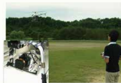
無人航空機に搭載した小型レーザスキャナと操縦練習中の様子
