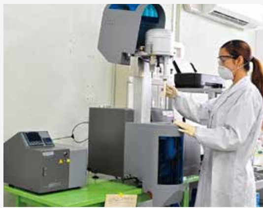
セシウムが高温環境によってどのような蒸発、エアロゾル形成挙動を示すのか、水蒸気中での超高温熱分析等を用いて調べています。
