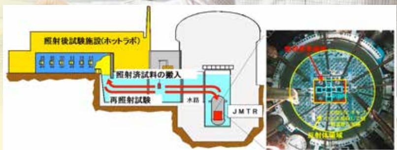
▲材料試験炉(JMTR)とホットラボ:実機材料の経年変化の研究には今後とも、材料試験炉の果たす役割は大きく、今後の研究計画の中でも活用を検討している。
