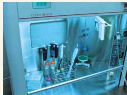
▲研究室に設置されたクリーンベンチ
