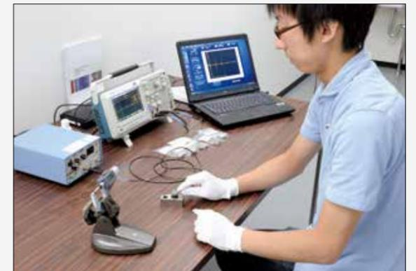
非破壊劣化診断のための超音波測定
