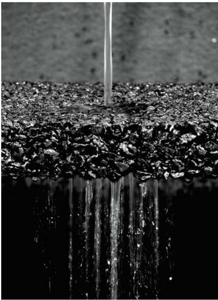
この写真は、排水性舗装の供試体上面に水を注いで、水が速やかに供試体の間隙を通り抜けて下面から排水される様子を表現したものです。一般的な舗装の空隙率は3~5%程度と低く、水はほとんど浸透することがありません。一方、排水性舗装の空隙率は20%程度と高いために、雨水等は路面に溜まらず、舗装内の間隙を通して排水用の側溝に流れます。このような高空隙率の舗装を提供するために、極めて粘度の高い特殊なアスファルトが使われています。排水性舗装は1980年に開発され、排水機能の他に交通騒音の低減効果も兼ね備えています。
