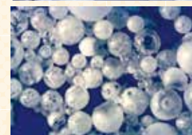
作製したマイクロカプセルの光学顕微鏡写真
